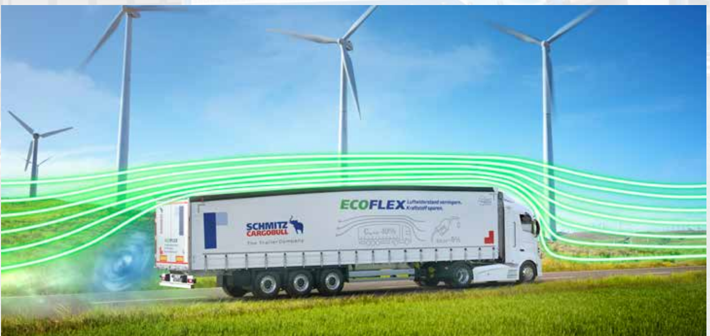
Schmitz EcoFlex: Das zum Heck hin absenkbare Verdeck sorgt für bessere Windschlüpfigkeit und einen geringeren Kraftstoffverbrauch der Zugmaschine.
