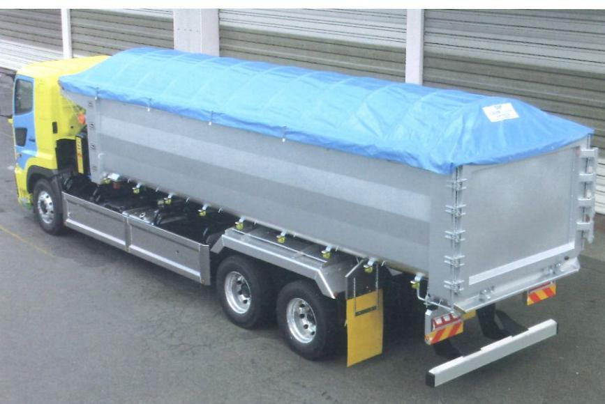
欧米ではオープントップ車には積荷の飛散防止に幌の装着が法律で義務付けられている。国内でも運転手を重労働で危険な幌掛け作業から開放するクロマ口製自動開閉幌装置(伊)の取付が進んでいる
